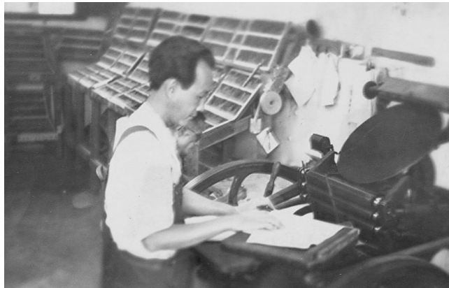
Rolando Chiong trabajando con la vieja máquina "Chandler 2", donada por el periódico chino de Estados Unidos "Wah Kiu". Posteriormente el periódico Kwong Wah Po se vio obligado a cerrar y pasar nuevamente a la clandestinidad, hasta que triunfó la Revolución cubana. Este equipamiento ha sido rehabilitado recientemente y todavía es utilizado para la producción de la imprenta del periódico, en su sede del barrio chino de La Habana.
